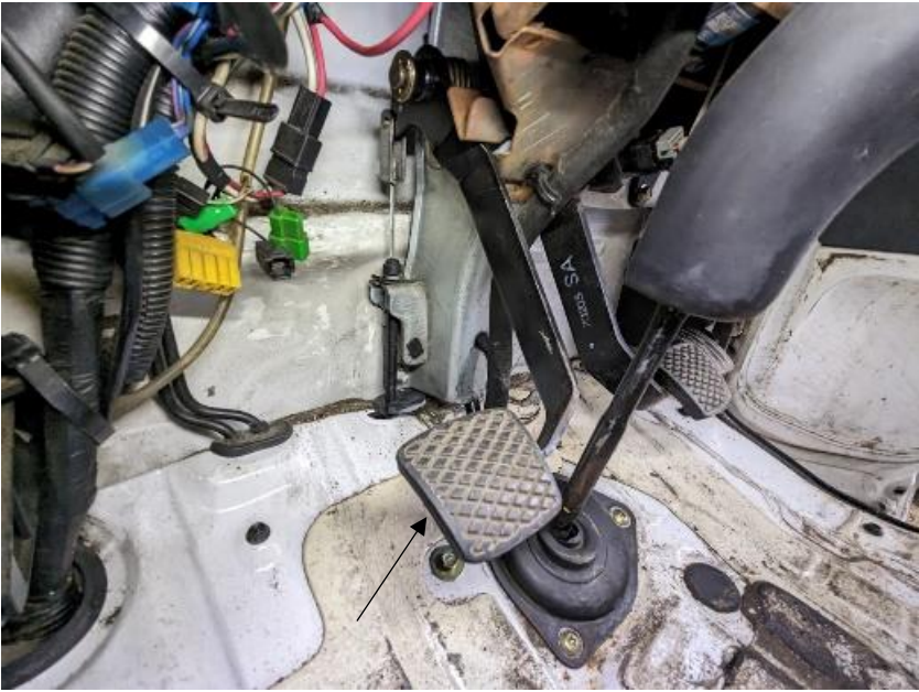
図 3-1 改造車のクラッチペダル取り付け部
