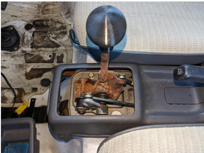
図 4-1 改造車のギアシフトレバー取り付け部
